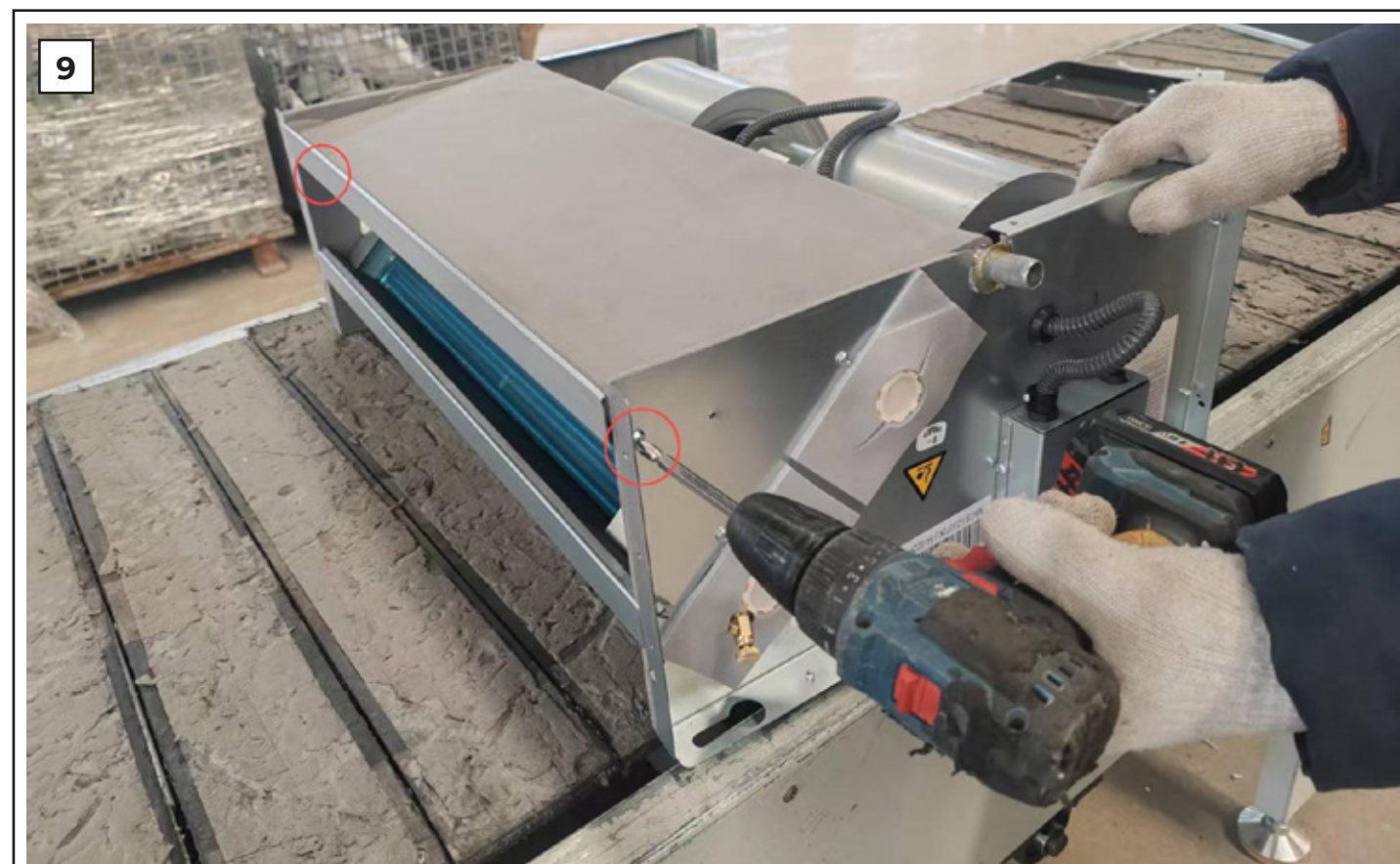
Снимите теплообменник (включая двигатель вентилятора и крыльчатку). Открутите 4 винта крепления теплообменника к верхней панели, рис. 8, открутите 2 винта между теплообменником и боковой панелью, рис. 9 (с обеих сторон).
