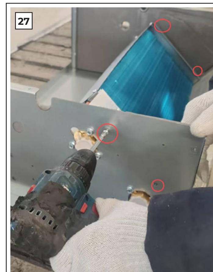
24-27: Вставьте теплообменник в отверстия на боковой панели рис. 24, затяните винты как показано на рис. 25-27 .
